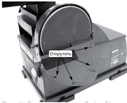
Рис. 14 Зняття кришки для заміни круга
